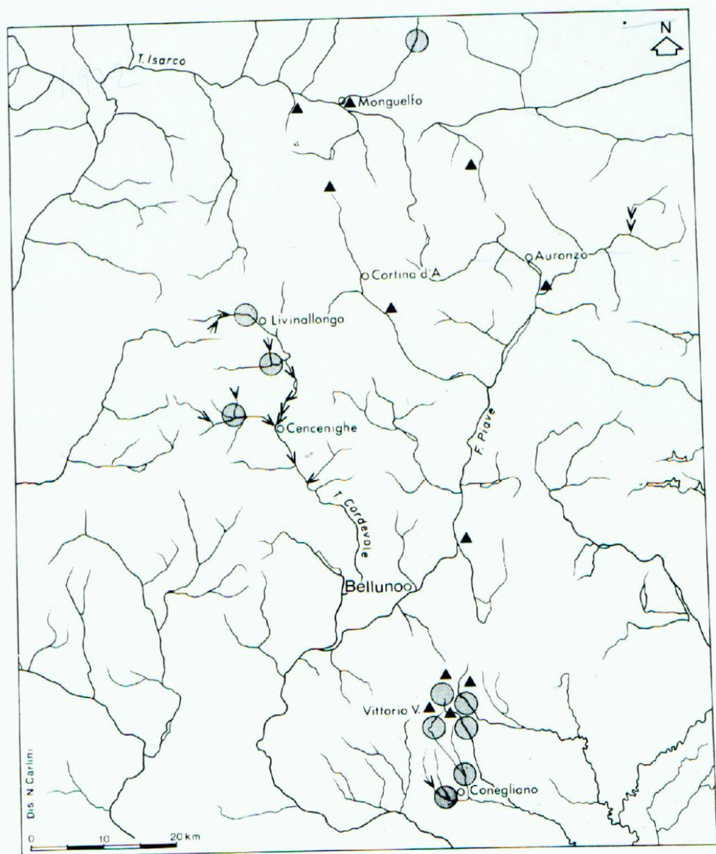
FIG. 5 - Indicazione schematica dei dissesti prodotti il 12 giugno 1972 nel Veneto orientale. I triangoli rappresentano le frane, le « V » i fenomeni erosivi lungo la rete idrografica e i tondini a fondo grigio le zone allagate o alluvionate.
